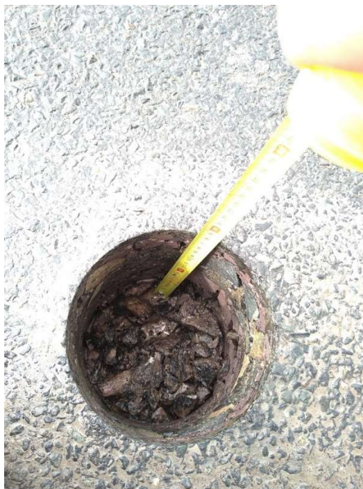
Obrázek 1 Otvor po jádrovém vývrtu
